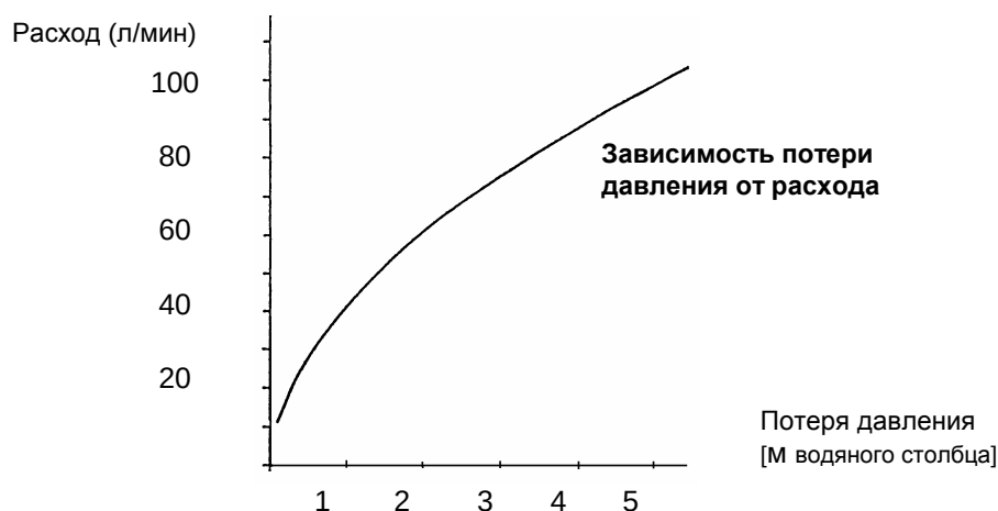
Рис. 14 Характеристика трехходового клапана Honeywell V 4044F
